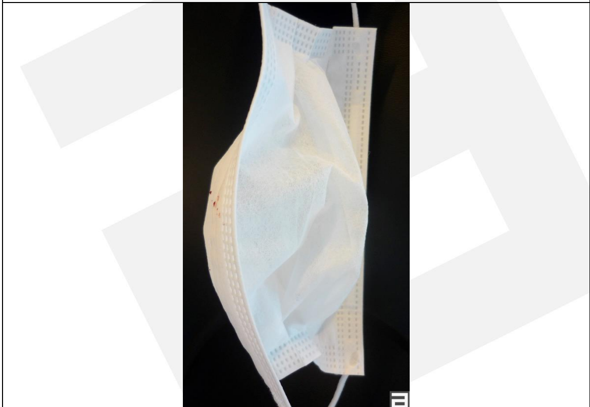
Cara interior: No se observa coloración de sangre sintética u otro tipo de penetración líquida.
